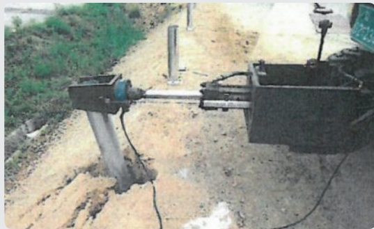
성도부 설치 방호울타리 수평지지력 시험 실시
