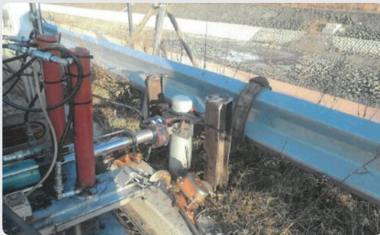
성도부 설치 방호울타리 수평지지력 시험 실시
