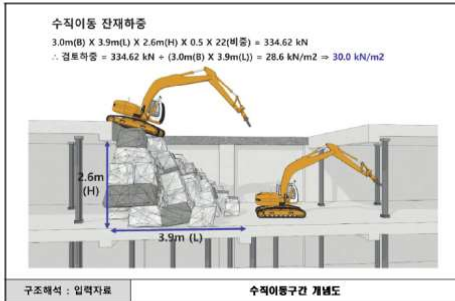
< [그림] 해체잔재물을 이용한 장비수직 이동 >
